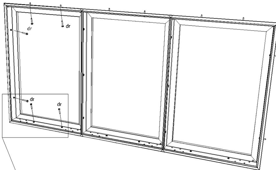
2. Закрепить раму в проёме во всех монтажных отверстиях
