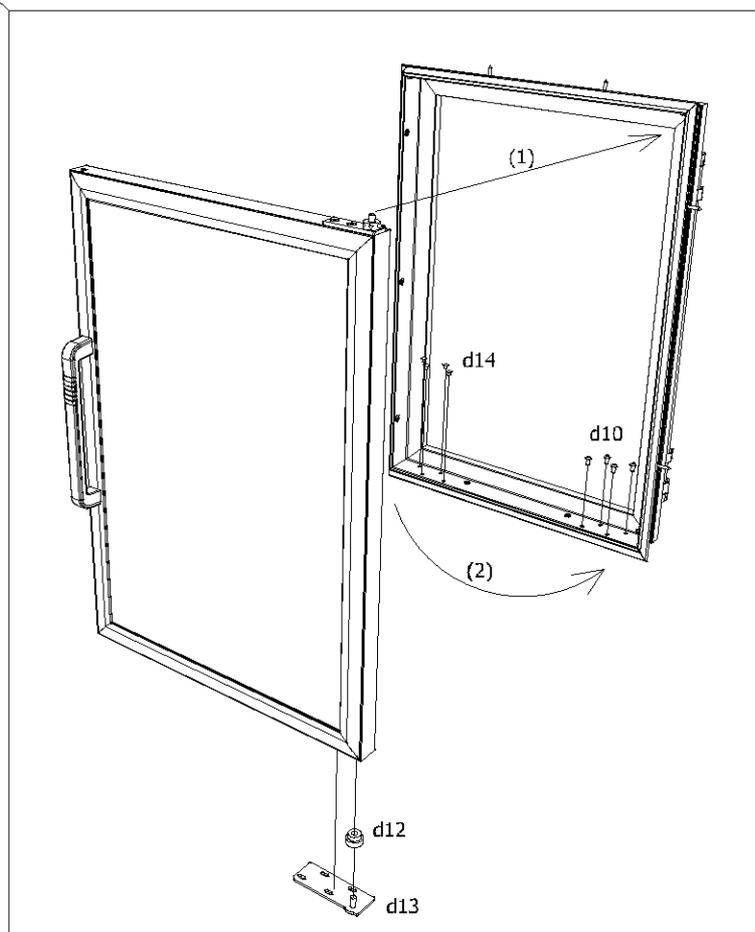
3. Выступающую часть верхней петли вставить в отверстие сверху рамы (1)
